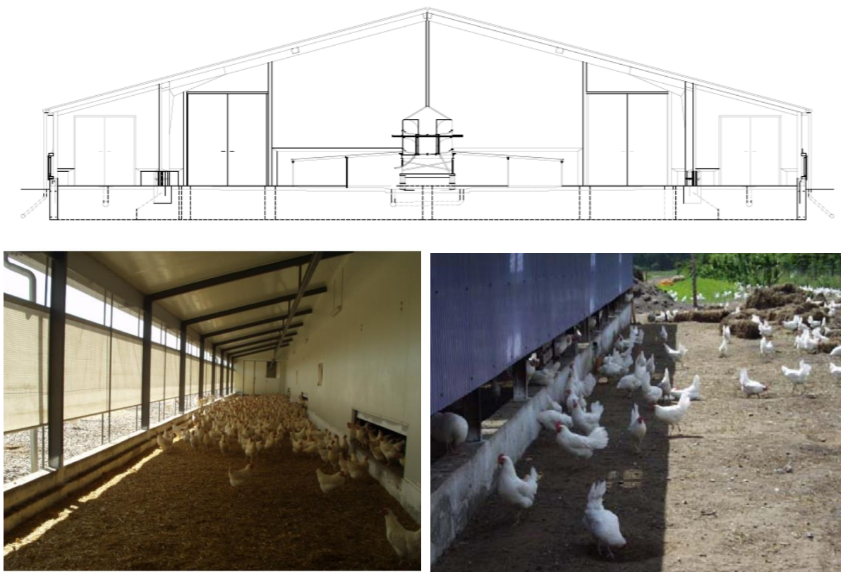
Figur 8.26. Øverst: Tværsnit af konsumægsstald (friland og økologisk produktion) med gulvdrift og gødningskumme samt overdækket veranda og adgang til udeareal. Nederst tv.: Veranda med åbninger langs facaden for adgang til stald samt udeareal. Th.: Høner i udeareal (Kilde: SEGES).
