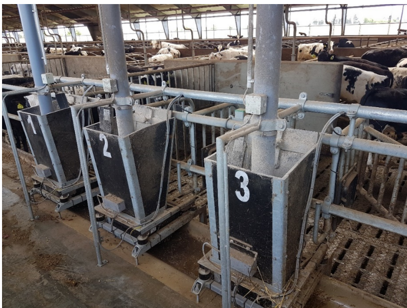
Figur 1. De tre Allflex foderkasser til registrering af kalvenes foderoptagelse af kraftfoder.
